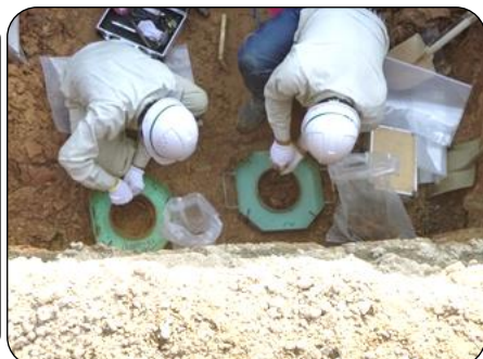
② 堤体下流側の開削調査 (右は現場密度試験の実施状況)
