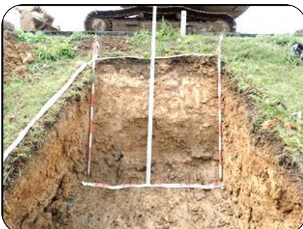
② 堤体下流側の開削調査 (右は現場密度試験の実施状況)
