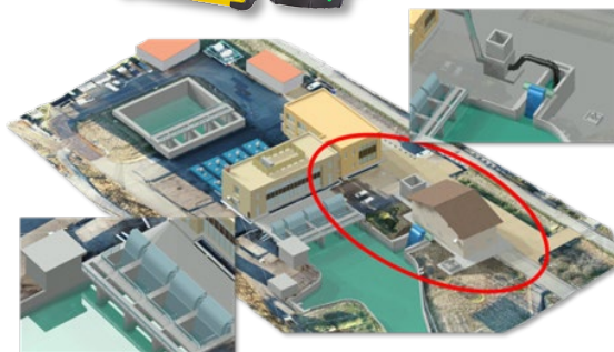
点群データから作成した3Dモデル（計画）
