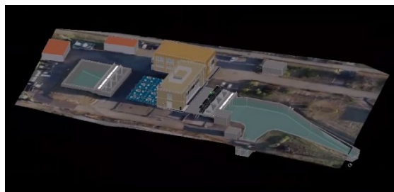
点群データから作成した3Dモデル（現況）
